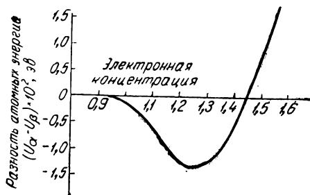
Рис. 5. Разность энергии Ферми для гранецентрированной и объемноцентрированной кубических решеток в зависимости от электронной концентрации. По данным Jones H. Proc. Phys. Soc. 49, 1937, 250
